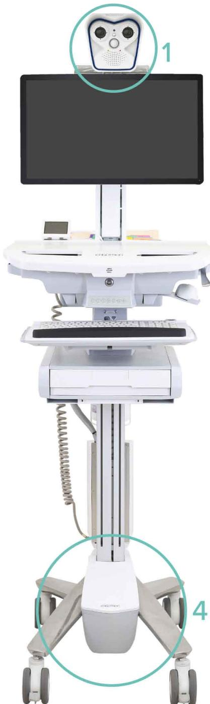
1. Caméra thermique orientable avant ou arrière pour la confidentialité
